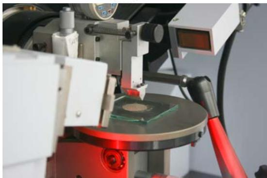
Imagen parcial del difractómetro de Rayos X
